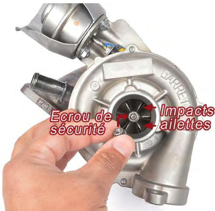
Problème survenu sur un turbo NEUF fraîchement monté lors du premier démarrage de moteur. Le mécanicien a effectué une accélération voiture immobile pour déclencher l'action du turbo et à cause d'un manque caractérisé de lubrification, une force particulière a été exercée sur l'axe de la turbine provoquant le dévissage de l'écrou de sécurité. Celui-ci a provoqué des dommages irréversibles aux ailettes.
